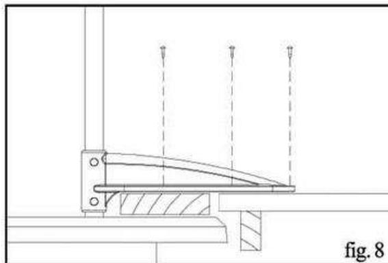
9. Si la hauteur de la plate-forme se trouve au dessus du niveau de la piscine, utilisez un bloc-espaceur\* pour obtenir le même niveau (Fig. 8). Assurez-vous que le bloc-espaceur\* soit bien fixé sur le siège.
